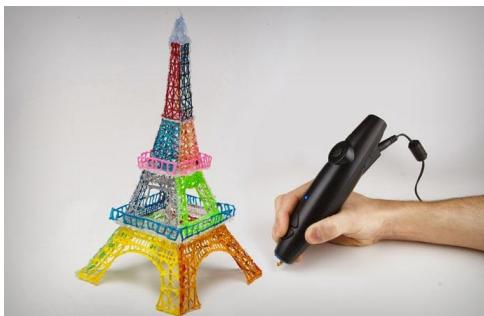
3D olovke rade na principu trenutnog zagrevanja plastične žice kojom se formira željeni oblik a zatim se na sobnoj temperaturi vrlo brzo hlađi čime napravljen oblik ostaje u čvrstom stanju. Korisne su prilikom pripreme koncepata ideja.
